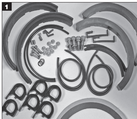
1 シール部品を作業台の上に置きます。
