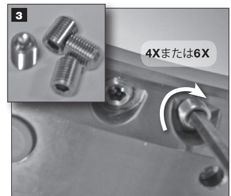
3 新しいカップポイントセットスクリューを潤滑し、回転ホルダーに取付けます。
